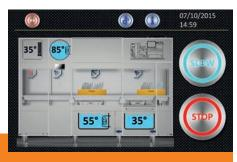
sualizzazione delle temperature, fasi di lavoro tramite immagini, stato della macchina, orario e eventuali anomalie. Indicatore dello stato della macchina visualizzato con differenti illuminazioni. Interfaccia USB per l'interscambio di dati. Registro della quantità di cicli effettuati giornalmente e nell'arco di vita della macchina.
