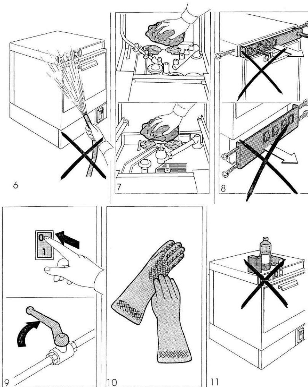
Не опрыскивайте машину водой (рис. 6).
