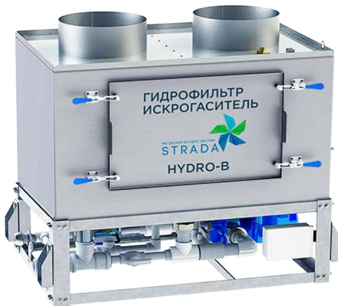
Гидрофилтр STRADA HYDRO В, обеспечивает полное искрогашение, удаление сажи и жира, части дыма и части запаха, снижает температуру до 30 – 40 С.
