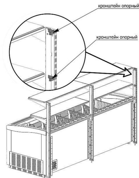
8. При монтаже двухсторонней суперструктуры, смежную витрину придвинуть спиной, вплотную к суперструктуре. Установить панели перфорированные между стойками.
