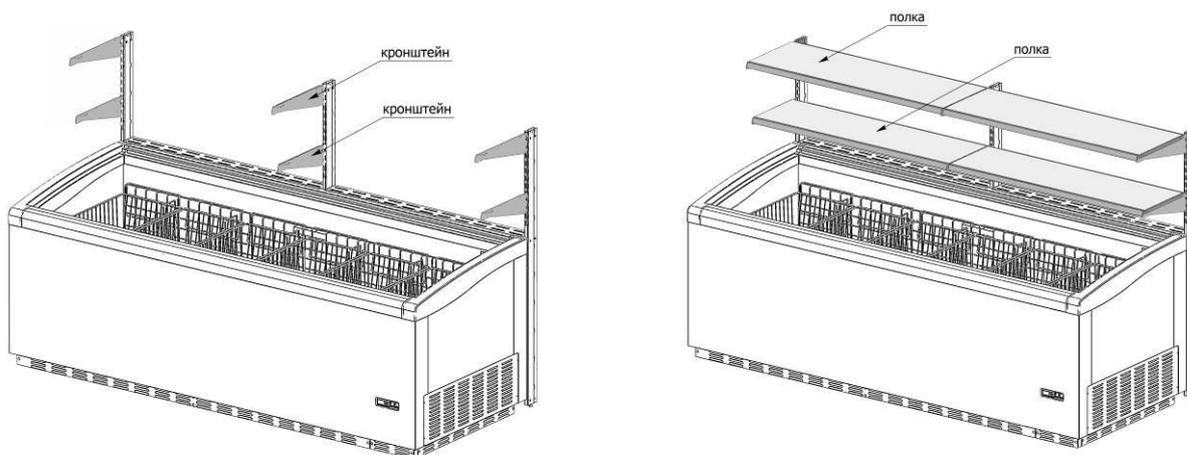
7. При монтаже односторонней суперструктуры, установить на внутреннюю сторону стоек кронштейны опорные. Закрепить кронштейны саморезами с прессшайбой 4,2x16 со сверлом, на одном уровне с поверхностью полок.
