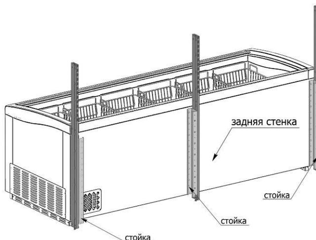
4. При монтаже односторонней суперструктуры, установить между стоек панели перфорированные, закрепить саморезами с прессшайбой 4,2x16 со сверлом, по отверстиям.
