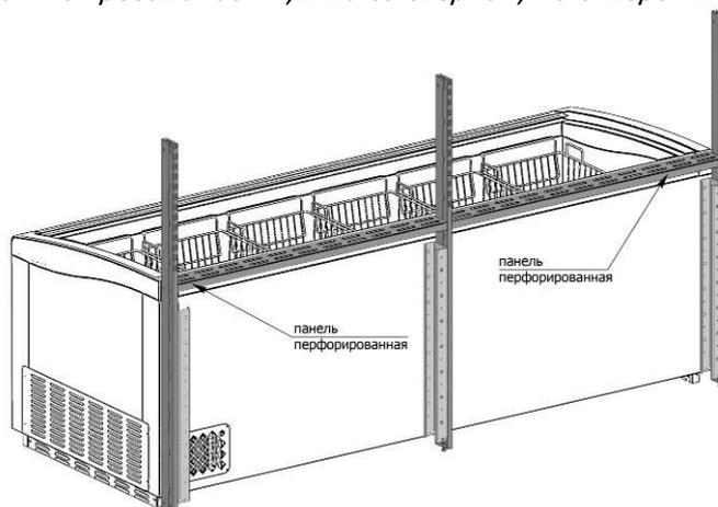
5. Выкрутить до упора в пол, опорные болты стоек суперструктуры
