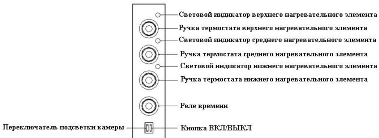
Кнопка включения/выключения отвечает за контроль всех элементов печи. Использование терmostатов возможно только после нажатия этой кнопки. Световые индикаторы отключаются, когда печь нагреется до необходимой температуры.
