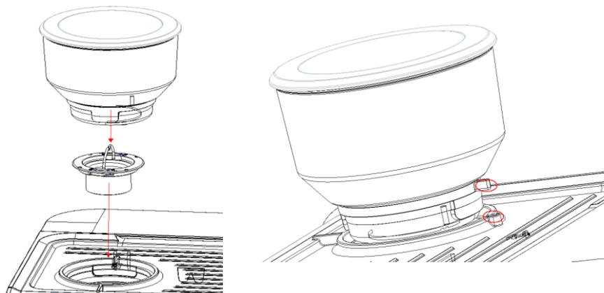
Бункер для зерен имеет отметку, как показано на рисунке ниже, которая используется для настройки грубости помола. Отметка на бункере для зерен совмещается с верхней крышкой.
